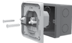
Рисунок 8. Установка терморегулятора в монтажную коробку
